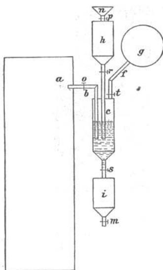
c hindurchgeleitet wird, so daß die etwa im filtrierten Gase vorhandenen Verunreinigungen die Flüssigkeit trüben.
