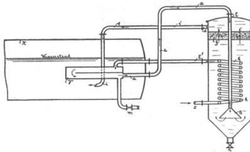
terbehälter r, dann den Vorwärmbehälter v, darauf den Filterbehälter r selbst und dessen Filter f durchströmt, um schließlich in den Dampfkessel zu gelangen. —
